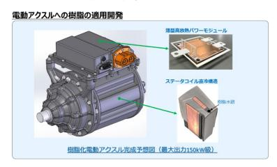
これら開発品を適用した最大出力 150kW 級の樹脂化電動アクスルを今年度中の組立を予定しており、その後、実際に動かしてデータを取得、放熱性向上等の性能改善を国内外の自動車関連大手に具体的に提案します。また本開発により製品の販売に留まらず、顧客の製品開発に寄与する技術提供を可能とし、当社樹脂事業のより一層の拡大を図るとともに脱炭素社会の実現に貢献します。
