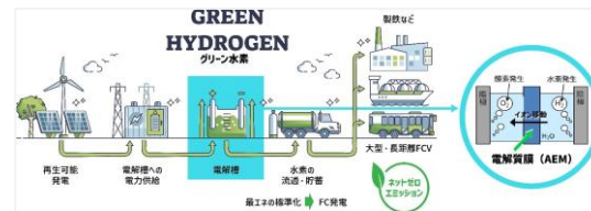
グリーン水素製造プロセス(当社材は「電解槽」に使用)
