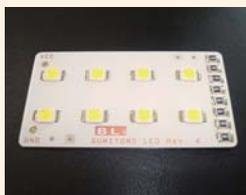
ジット両面銅張板「ELC-4970SC」の開発によりLED照明、バックライトの効率向上・高寿命化を実現しています。さらに熱伝導を高めた材料の開発により、LED照明の普及による省エネルギーに貢献します。
