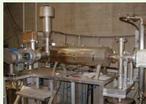
水平移動床式ガス化実験装置
