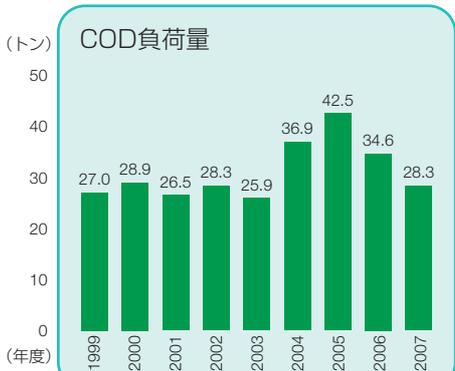
\*2004、2005年度は活性汚泥処理装置における汚泥の沈降不良により、COD負荷量が増加しましたが、その後運転条件の見直しにより順調に回復しつつあります。
