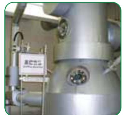
廃イソプロピルアルコールの蒸留回収装置
