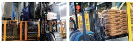
AGV(無人搬送車)による運搬作業の自動化
