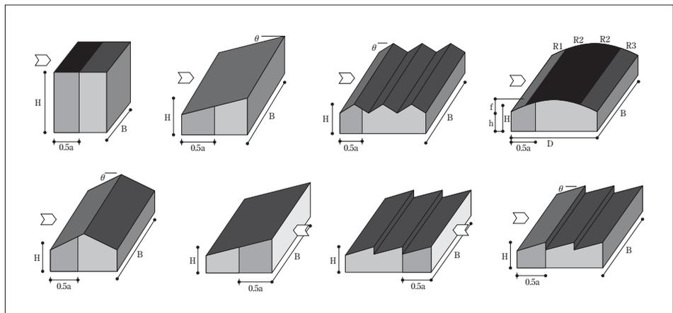
図7 閉鎖型の建築物（けた行方向に風を受ける場合。表10、表11、表14を用いる）
