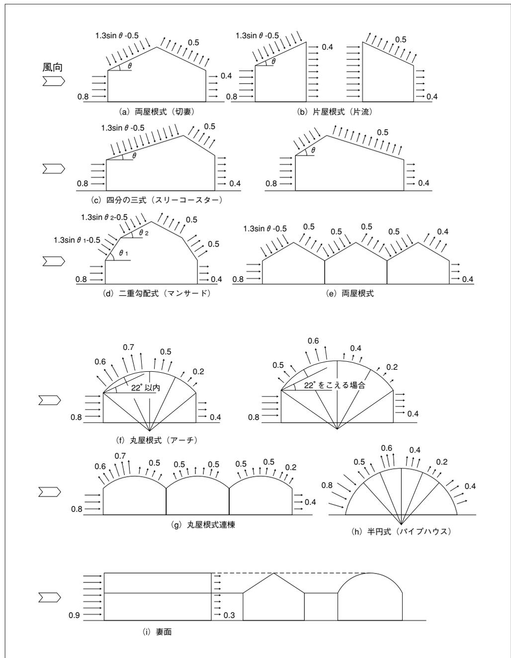
(3)式を利用し、屋根の風力係数を一般の場合 $C=0.5$ 、局部風圧を受ける場合 $C=1.5$ とすると風圧力は下表のようになります。
